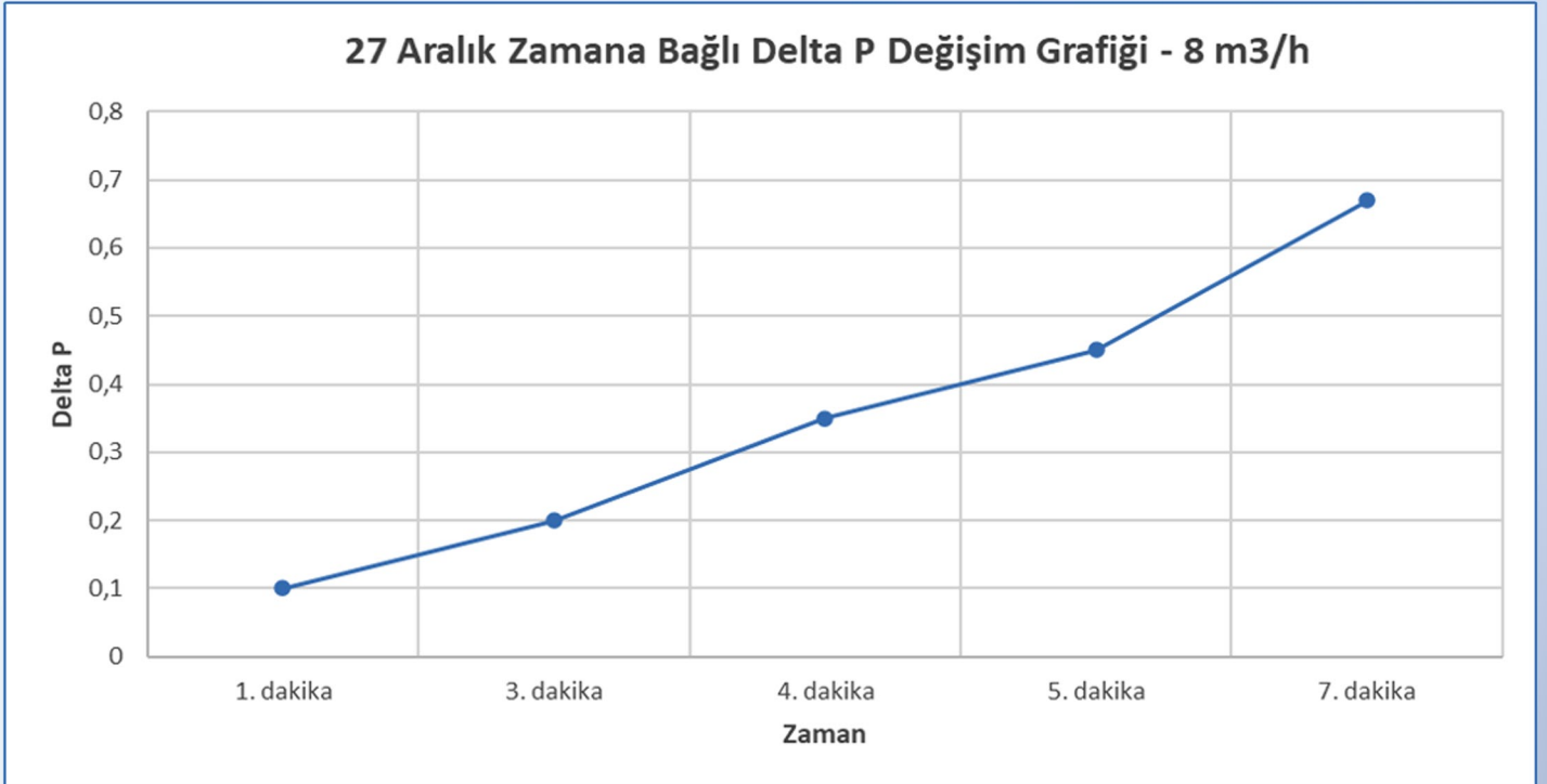
Grafik 1.2. 50 mikron FMS-V-MR Model Filtrede Zamana Bağlı Delta P Değişim Grafiği- Tambur Filtre Çıkışı- FMS-V-MR Filtre Girişi
